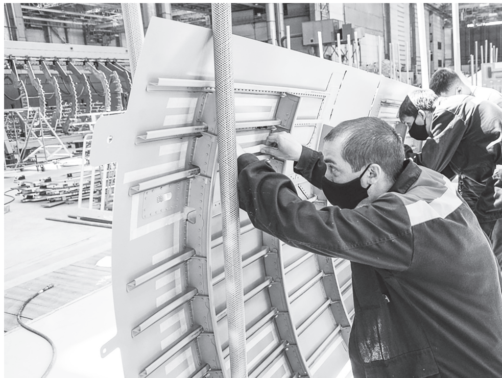
В июне на «Авиастаре» завершено изготовление панелей фюзеляжа для нового российского регионального турбовинтового пассажирского самолета Ил-114-300. Агрегаты отгружены на нижегородский авиастроительный завод «Сокол» - филиал АО «РСК «МиГ». «В этом году мы уже отправили в Нижний Новгород панели фюзеляжа с целью дальнейшей сборки второго опытного образца самолета Ил-114-300, создаваемого по серийным технологиям», - прокомментировал директор программы по изготовлению авиационной техники АО «Авиастар-СП» Григорий Истомина. - Далее приступим к работам по изготовлению комплектов люков и дверей. Планируем до конца года отправить все агрегаты на второй самолет».
